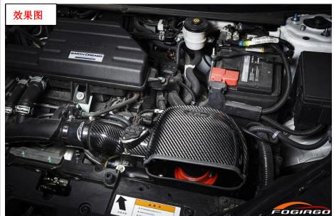
**安装步骤:** 1, 先拆下原厂支架上的螺丝及胶塞装到碳纤风箱上的对应位置; 2, 将已装好胶塞的碳纤风箱底装车并扣实锁紧螺丝; 3, 安装进气管并套上冬菇头并用喉箍锁紧, 最后装上感应器, 装上风箱盖并锁紧。
