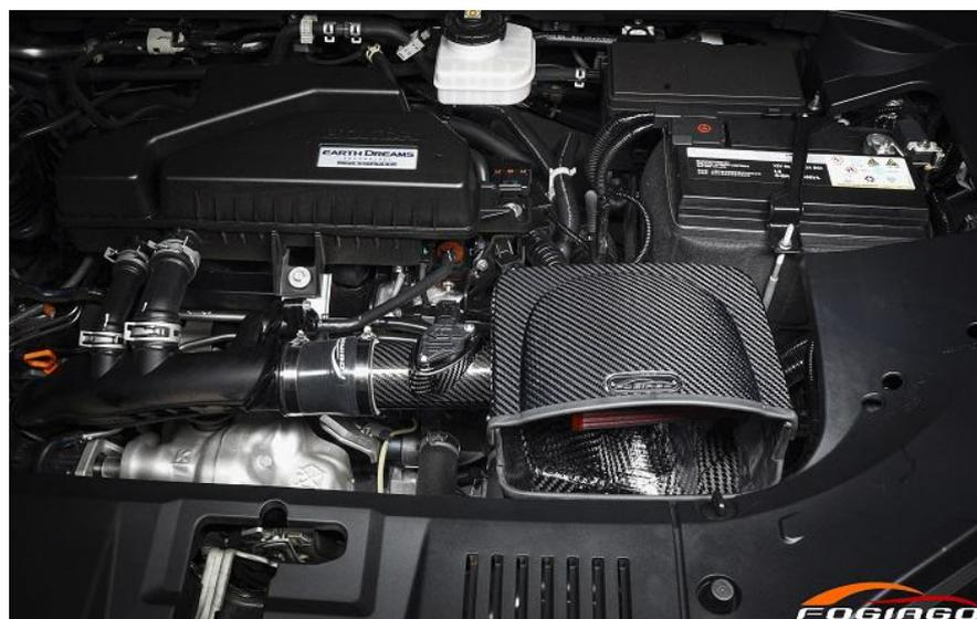
**安装步骤:** 1, 先将原厂定位胶塞螺丝拆下, 装到碳纤风箱对应的定位支架上; 2, 安装风箱底并锁紧螺丝; 3, 连接进气管, 接冬菇头, 安装感应器, 锁紧; 4, 装上碳纤风箱盖, 锁紧。
