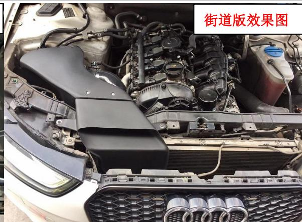
安装步骤：1 先将冬菇头锁到风箱上；2 将风箱底上的定位脚对准原厂胶座插上装车；3 将入风口连接风箱，装上螺丝锁紧；4 将冬菇头，原厂感应器管，硅胶，发动机进气管口连接锁紧。
