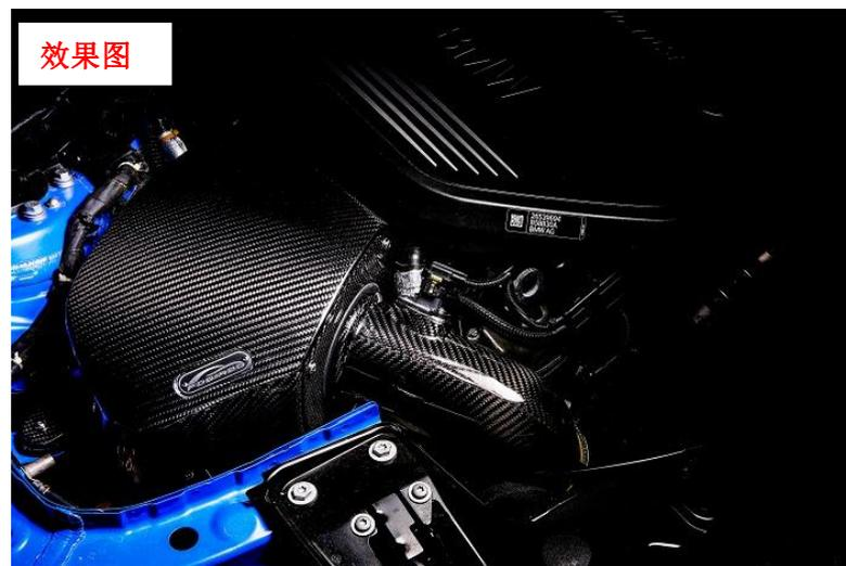
**安装步骤:** 1 拆下碳纤盖板, 将进气管穿过盖板接上冬菇头锁紧, 然后将盖板组装回风箱锁紧; 2, 将原厂风箱底部的胶塞拆下, 装到碳纤风箱底对应的孔位上; 3 在发动机进气接口上套上硅胶管及喉箍, 先不要锁紧, 然后将组装好的碳纤风箱装车, 对应好各定位, 入风插口, 接上硅胶, 按实, 进气管可转动调整, 合位后锁紧喉箍, 接上感应器。
