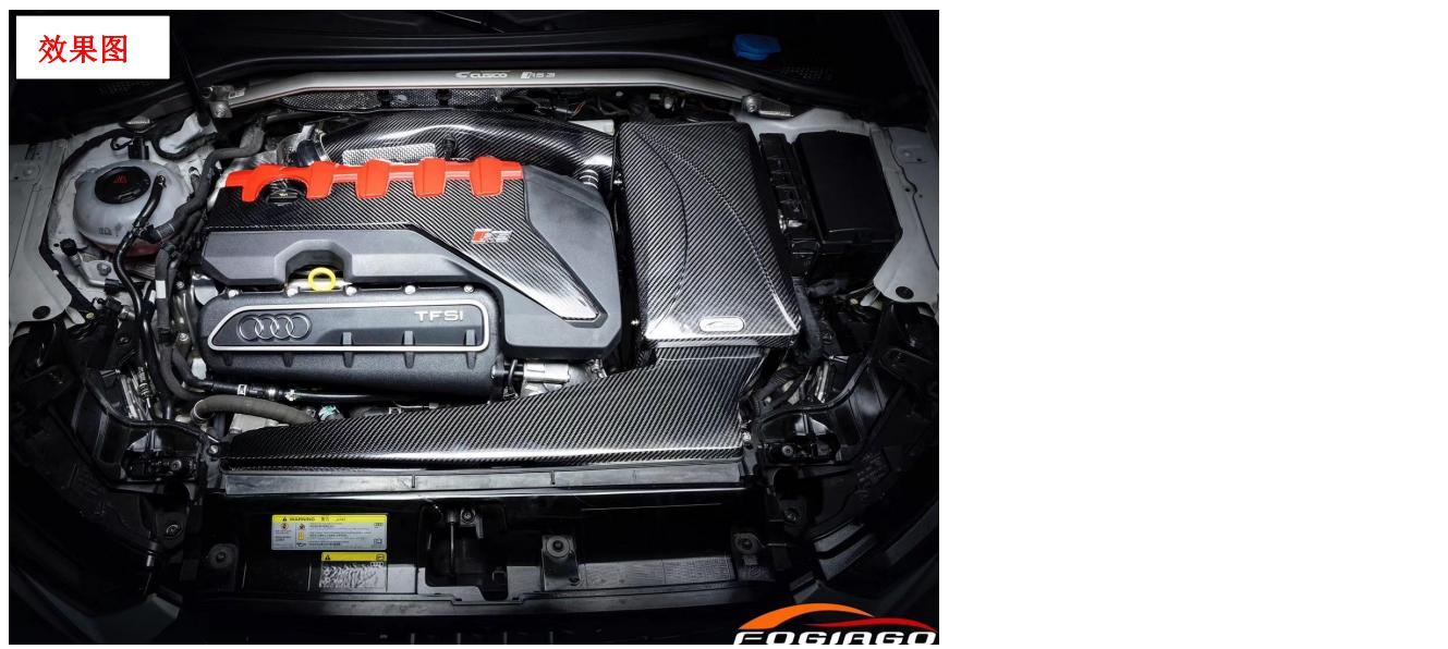
安装步骤：1 先将导风管插入风箱底，同步装车，先对位导风管位置，对位后先螺丝固定，勿锁紧，然后对位风箱底安装位，对位后按实卡扣；2 套上硅胶安装进气管，接上卡管，硅胶软管，冬菇头，锁上定位螺丝；3 安装风箱盖锁紧。
