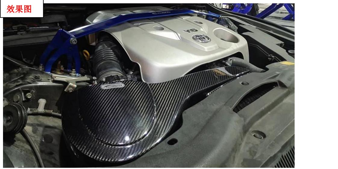
安装步骤：1 先将进气管插到盖板上，连接上冬菇头并锁紧，然后装回到风箱上锁紧盖板；2 拆下原厂导风口位置盖板，安装风箱，导风口两侧用原厂螺锁紧，连接进气管锁紧；3 装回原厂盖板，卡上原厂胶扣，装上感应器锁紧。
