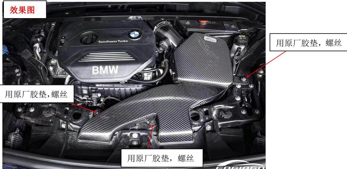
**安装步骤:** 1 拆下原厂缓冲胶垫, 装到对应的碳纤风箱套件上; 2 拆下碳纤盖子, 将进气管套进风箱, 内侧接上冬菇头并锁紧; 3 将组装好的风箱装车, 对准螺丝及胶垫位, 扣实锁紧, 连接上进气管并锁紧; 4 安装碳纤导风管, 对准螺丝位及风口位, 吻合后锁紧; 4 装回碳纤盖板并锁紧, 安装完成。
