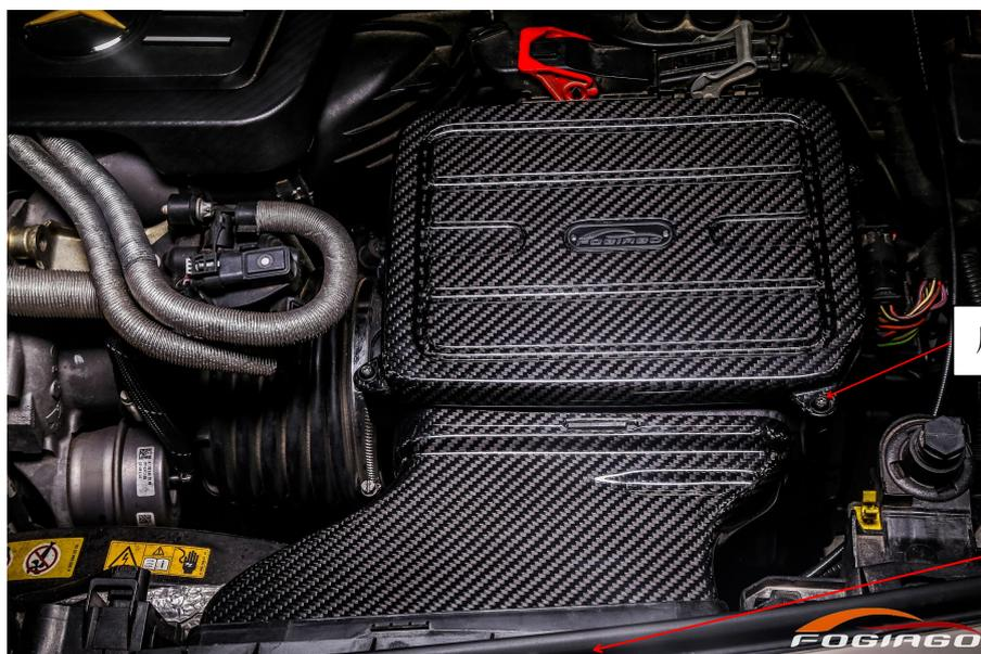
**安装步骤:** 1 将原厂风箱盖, 进风管及风格及接头拆下; 2 将 FOGIAGO 接头铝件装到原厂风箱底座上, 锁上螺丝; 2 安装碳纤进气管, 连接处可先贴上防震棉; 3 安装冬菇头锁紧, 装上碳纤风箱盖板; 4, 拆下车前挡板, 在进气口安装导风板。
