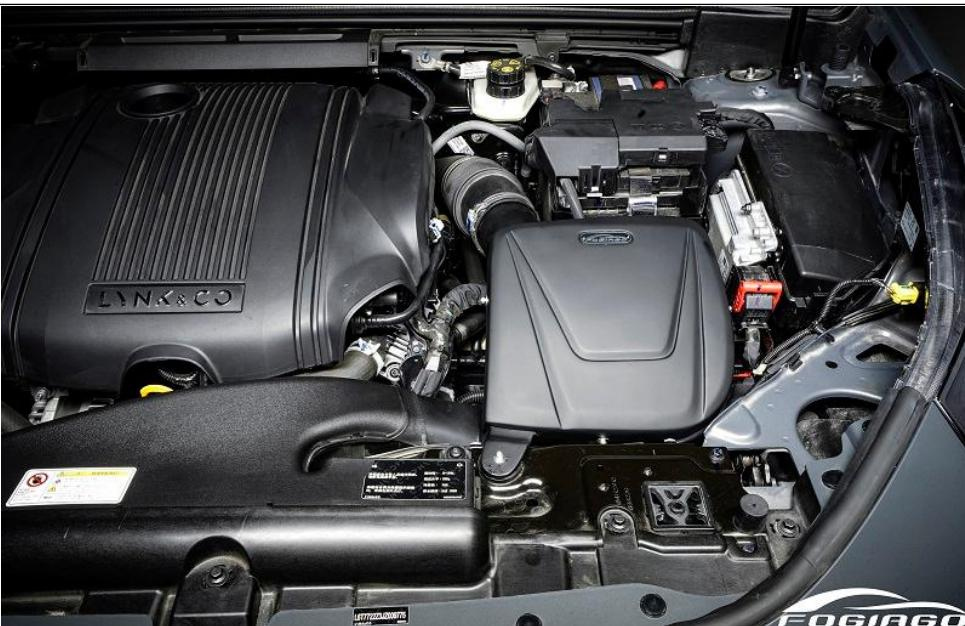
**安装步骤：**1 拆下原厂入风口及原厂风箱；2 安装碳纤风箱底座，将定位脚对准胶塞位扣实；3 安装原厂入风口，插入风箱入风端接口，对位后用回原厂螺丝锁紧；4 将进气管接上冬菇头锁紧，然后将进气管卡到风箱底上的 U 形卡槽上，连接上原厂进气软管锁紧；5 安装碳纤风箱盖并锁紧。
