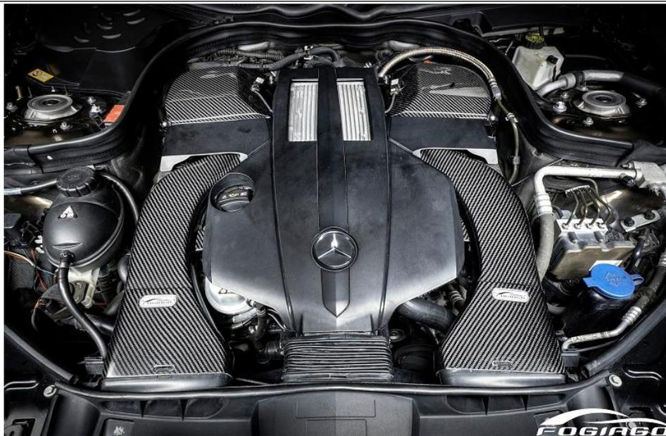
**安装步骤：**1 拆下原厂左右风箱盖，进气管，原厂风格；2 安装进气管，将原厂风箱底座抬高，插上碳纤进气管，进气管两端插好后扣紧原厂风箱底座；3 安装风箱盖，用原厂螺丝锁紧，插上感应器扣好；4 拆下原厂风箱盖及进气管上的胶塞，扣到对应的碳纤定位支架上，然后装上原厂发动机盖，接回原厂机盖连接处软胶。
