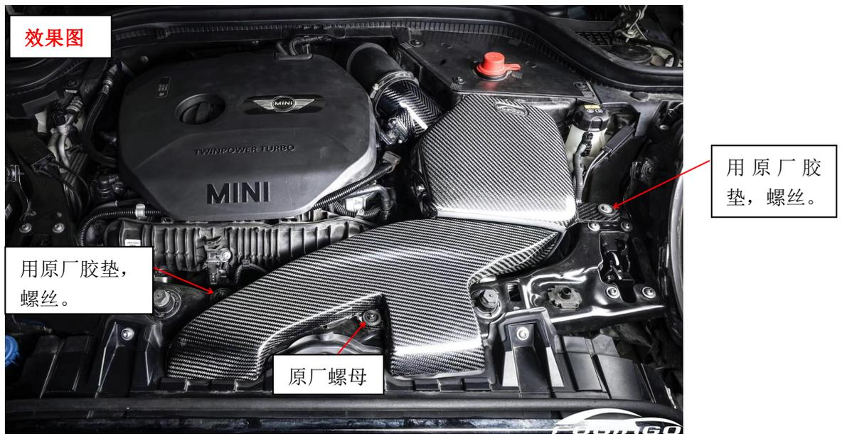
**安装步骤:** 1 先将原厂胶垫拆下装到碳纤风箱及导风管对应的定位脚上; 2 将进气管连接上风箱, 接上冬菇头锁紧, 然后将组装好的风箱装车, 对准胶垫扣上, 接上进气管锁紧; 3 安装导风管, 锁上原厂螺丝; 3 安装风箱盖, 装上感应器, 锁紧。
