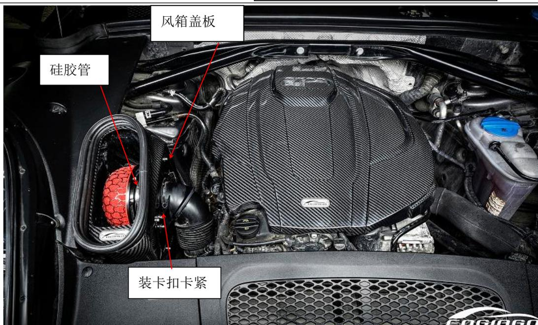
**安装步骤：**1，拆下原厂风箱上的胶塞及螺丝装到对应的碳纤风箱上；2 拆下碳纤风箱盖板，在碳纤盖板内侧套上硅胶管，接上冬菇头并锁紧，然后再将盖板装回到风箱上并锁紧；3 将组装好的风箱装车，定位脚对准原厂胶塞位插上，再对位定位支架，用原厂螺丝锁紧；4 将原厂进气管套进碳纤盖板对应孔位，用卡扣卡位锁紧；5 粘接原厂胶边条。
