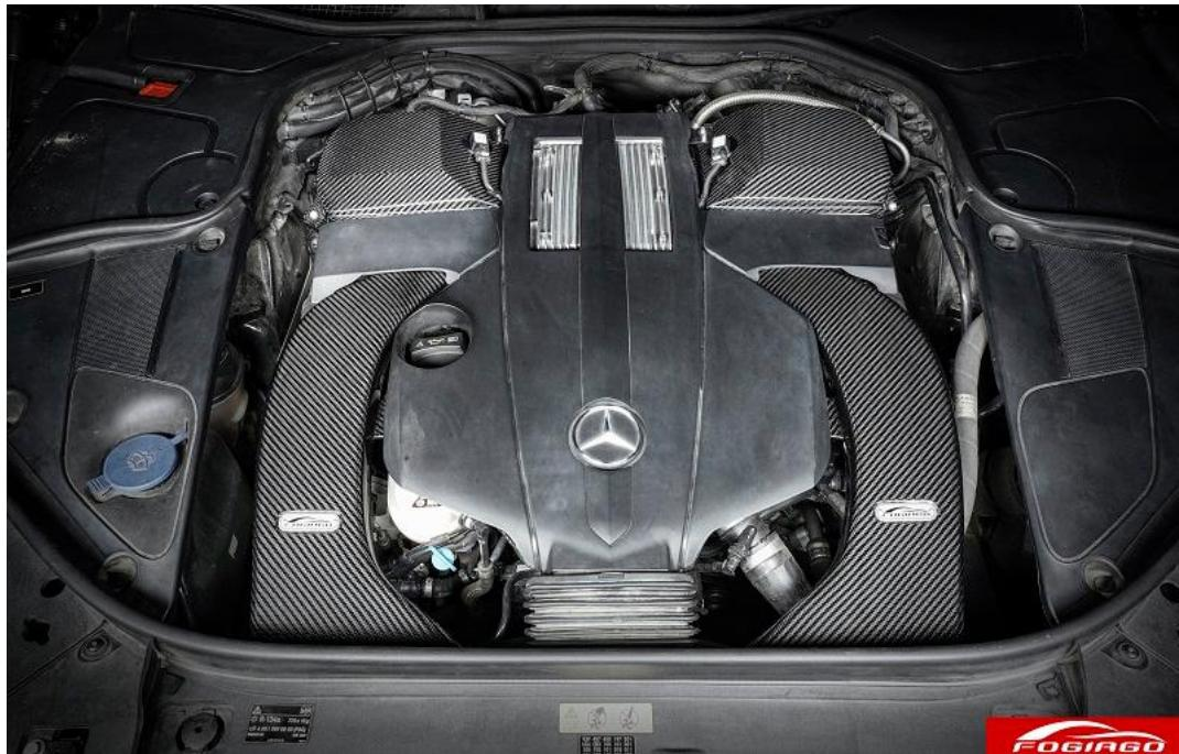
**安装步骤：**1 拆下原厂左右风箱盖，进气管，原厂风格；2 安装进气管，将原厂风箱底座抬高，插上碳纤进气管，进气管两端插好后扣紧原厂风箱底座；3 安装风箱盖，用原厂螺丝锁紧，插上感应器扣好；4 拆下原厂风箱盖及进气管上的胶塞，扣到对应的碳纤定位支架上，然后装上原厂发动机盖，接回原厂机盖连接处软胶。
