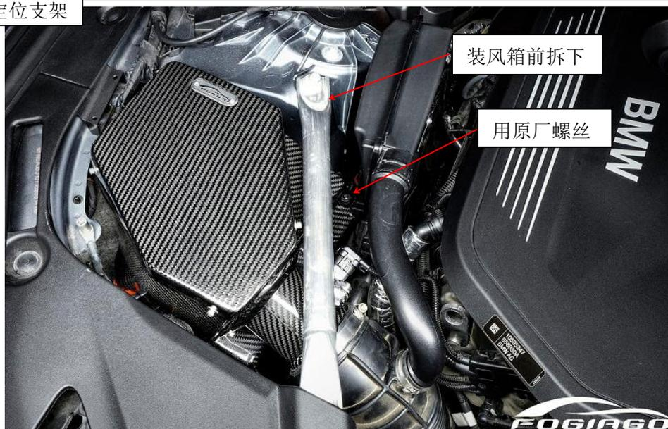
**安装步骤：**1 将碳纤进气管插到风箱上，接上冬菇头锁紧，然后将进气管锁到风箱上，装回碳纤盖板并锁紧；2 将组装好的碳纤风箱装车，对准进气管接口套上，同时对准定位脚扣子及入风口位置，对位后扣实锁紧；3 锁上碳纤支架上的原厂螺丝，装上感应器，及顶巴锁紧。
