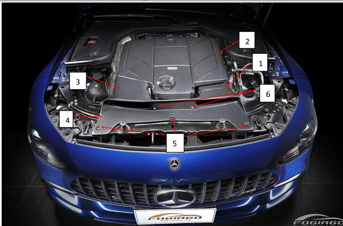
安装步骤：1, 拆下原件，更换风格；2, 安装风箱进气管；3, 安装引擎盖，引擎盖背面支架胶塞用回原厂；4, 安装机舱吹气管；5 安装导风口，最后装上不锈钢卡扣，将拉杆线用扎带绑定到不锈钢卡扣上。（碳纤套件具体安装步骤按图二标示）
