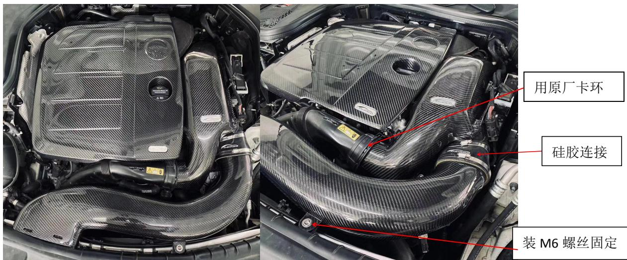
安装步骤：1 将原厂风箱盖、入风管拆下；2 将 HKS 过滤冬菇头安装到碳纤风箱罩上，然后按原厂位装车，插上废气管，风箱罩螺丝用原厂+垫片固定，进气管连接处用原厂卡环；3 安装碳纤入风管前需先拆下原厂导风口，将碳纤入风管插入风箱口，另一端插导风口，然后再装回锁紧原厂导风口，导风口支架处套上夹片螺母，再用螺丝锁上固定即可。
