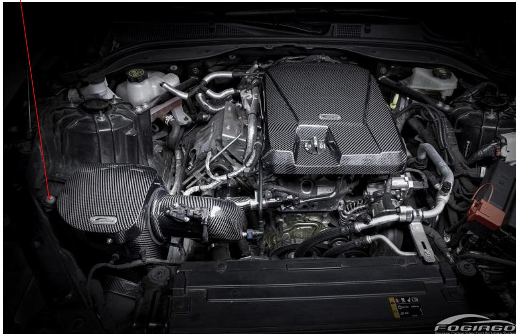
**安装步骤：**1，先将原厂进气管口上的原厂卡环拆下，套上硅胶管、喉箍；2，将碳纤管与风箱对接，内接冬菇头锁紧，然后再对应原装位装车，固定位的胶塞及螺丝均用回原厂件。
