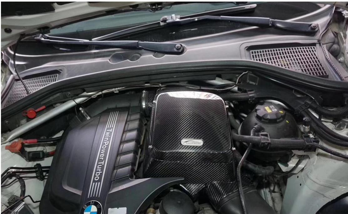
**安装步骤：**1，先将冬菇头接到风箱内锁紧，装回风箱盖，再将原厂风箱底上的胶塞拆下装到碳纤风箱上；2 将组装好的风箱原装位装车，锁紧后连接上原厂进气管和入风管。
