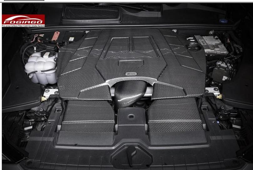
**安装步骤：**1，先将硅胶套在进气接头端口上，再安装进气接头，进气接头两侧用回原厂螺丝；2，安装风格，风格固定用回原厂螺丝；3，安装左右进气管；4，安装原厂水箱盖板，水箱盖板背后扣子要先扣住碳纤左右进气管后才按下前面的卡扣；5 按原装位扣上碳纤引擎盖，扣上两侧卡扣即可。
