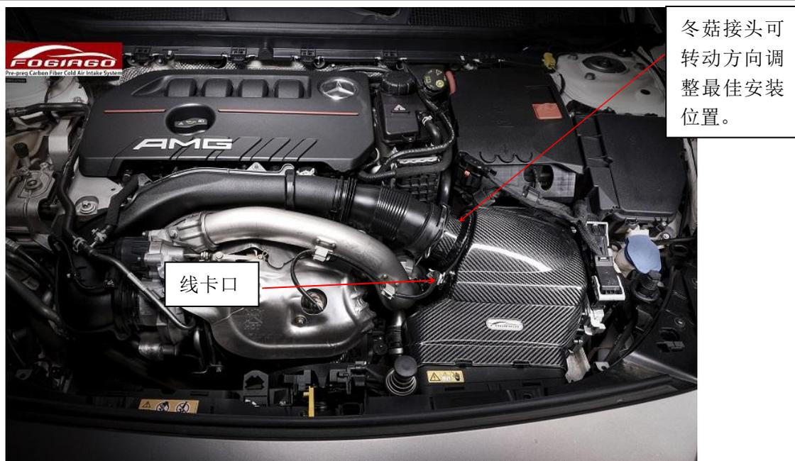
**安装步骤：**1，先拆下原厂电脑板，将电脑板安装固定到碳纤风箱上；2，将碳纤冬菇接头插到风箱圆孔上，内侧接上冬菇头并锁紧，冬菇不宜靠太紧，接头管子要可以转动调整；3，装上碳纤盖子并锁紧；4 将组装好的碳纤风箱对准原装位安装即可，接头连接处用回原厂卡环，最后插上电脑线端口扣紧。
