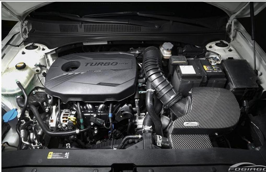
**安装步骤:** 1, 拆下碳纤风箱盖板, 将碳纤进气管套入盖板, 内侧接冬菇头, 然后再将盖板装回风箱; 2, 将原厂胶塞拆下装到碳纤风箱对应的支架上; 3, 将组装好的碳纤风箱原位安装。
