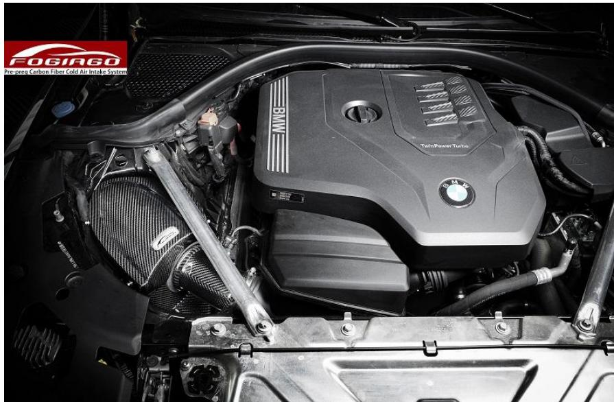
安装步骤：1，拆下原厂进气风箱，将风箱对应支架上的胶塞装回原位；2 将碳纤风箱盖板拆下，接上碳纤进气管，风箱内侧接上冬菇头，锁紧后要确保碳纤进气管能转运调整；3，碳纤进气管上套上硅胶，喉箍，然后对应好进气管连接口及风箱定位胶塞位安装即可。
