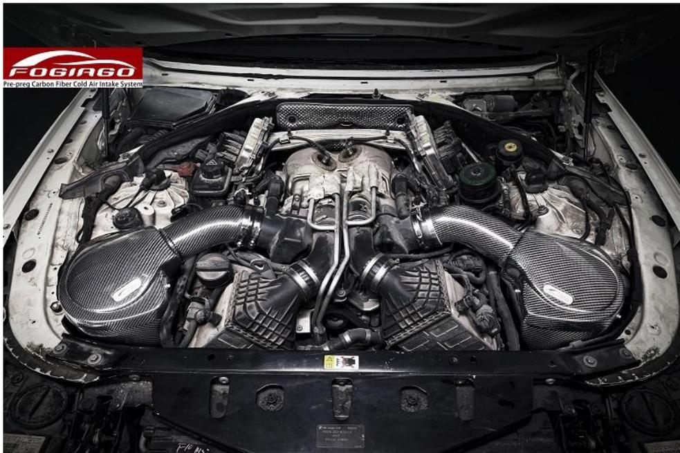
**安装步骤:** 1 拆下原厂缓冲胶垫, 螺丝, 装到对应的碳纤箱子支架上; 2 将碳纤进气管穿过风箱, 内侧接上冬菇头, 然后另一端套上硅胶对位装车; 3 锁紧定位脚螺丝, 锁紧冬菇头后再锁紧硅胶管; 4 装感应器, 安装风箱盖板。
