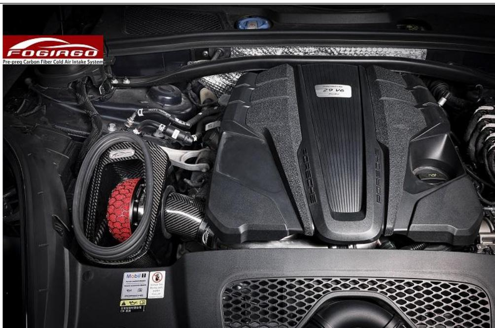
**安装步骤：**1 将原厂风箱定位支架上的胶塞及螺丝装到碳纤风箱对应的支架上；2 将 HKS 冬菇头及对接的硅胶放入风箱内，再将硅胶接到冬菇头上，然后插碳纤管对接，另一端套上硅胶管；3 将组装好的碳纤风箱对位装车，吻合后锁紧螺丝及喉箍即可。
