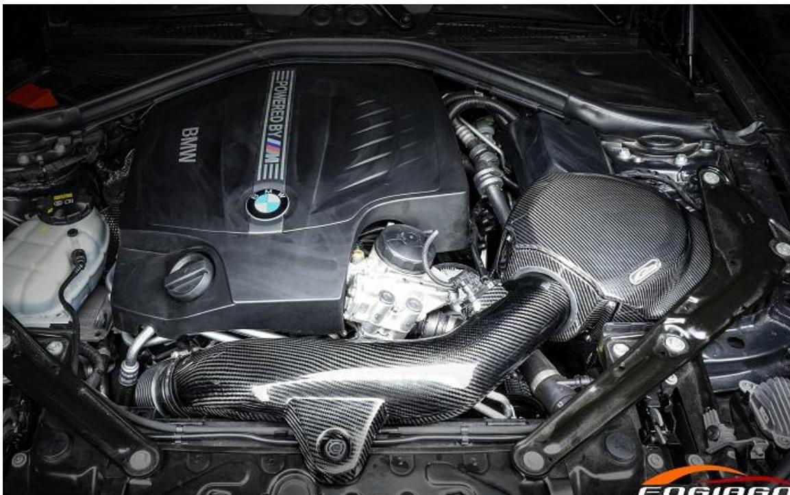
**安装步骤：**1 拆下碳纤盖板，将进气管穿过盖板，内侧接上冬菇头并锁紧，然后将盖板装回风箱上；2 将组装好的风箱装车，原厂位对接安装即可；3 装上感应器，安装完成。
