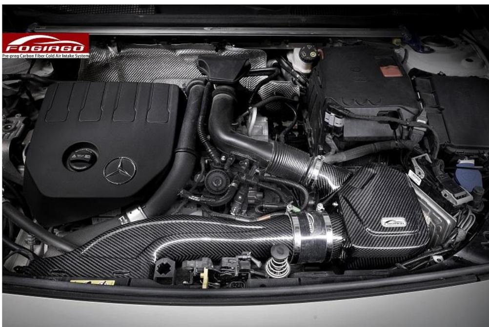
**安装步骤：**1 先将进气管对接的风箱上，内侧接上冬菇头，进气管可转动为宜；2 将原厂定位胶套装到铝脚上，然后对位安装风箱；3 安装入风管，用硅胶对接锁紧；4 装回风箱盖板，电脑板摆放到风箱侧面空档位置，用扎带绑定到相邻管路上。
