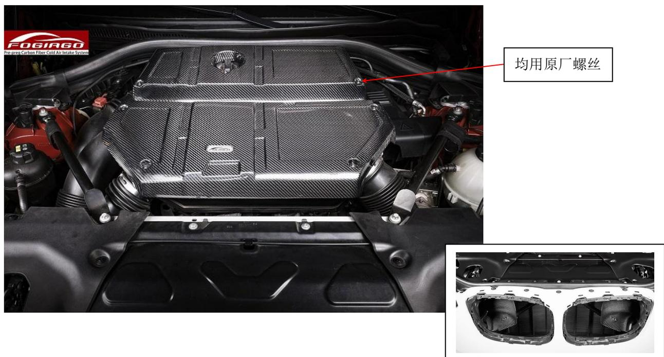
安装步骤：1 原厂位替换 BMC 风格；2 将原厂发动机罩标牌拆下，装到碳纤机罩上，碳纤发动机罩的安装均用回原厂螺丝；3 拆下中网，按左右区分插扣安装左右导风口。
