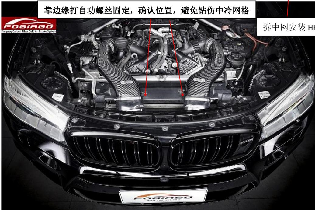
**安装步骤：**1 拆下原厂感应器底座，安装到碳纤管对应的铝底座上；2 拆下中网，然后依次安装左右长碳纤管，硅胶管，碳纤小管，硅胶管，HKS 冬菇头，调整好位置后固定锁紧。3 插上感应器线，扣回中网。
