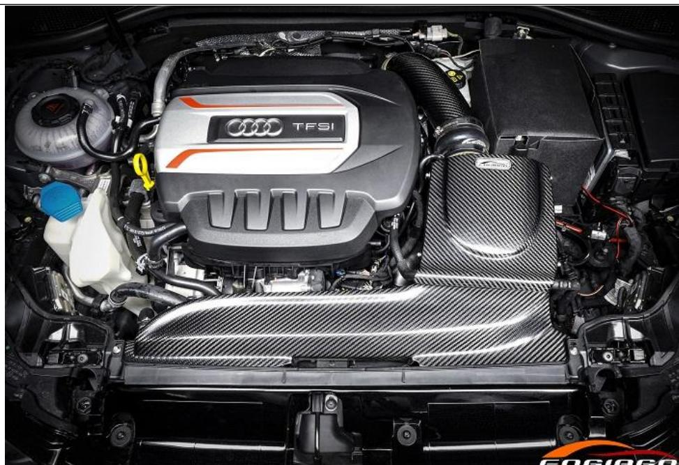
**安装步骤:** 1, 拆下风箱盖, 将箱体装到车上, 固定锁紧入风口两侧螺丝; 2, 将冬菇接头套到箱体上, 另一端接上冬菇过滤器并锁紧, 插上废气管; 3, 将原厂感应器管, 碳纤进气管, 用所配硅胶管对应连接并锁紧; 4, 套上风箱盖并锁紧。
