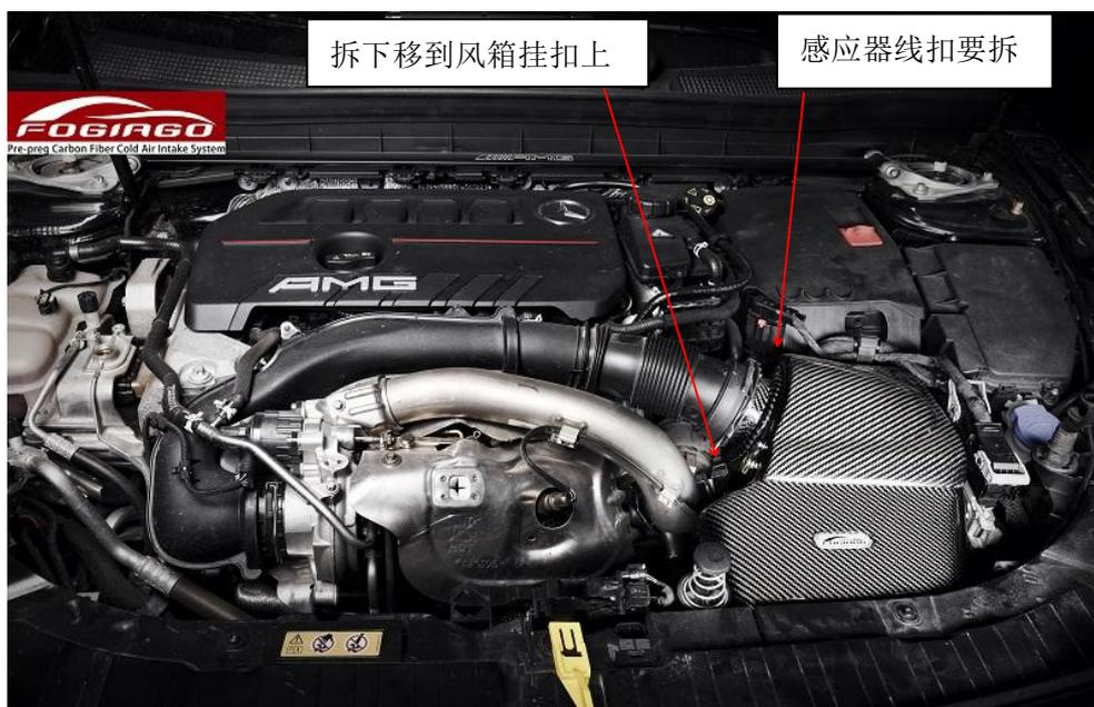
**安装步骤：**1 先将电脑板拆下装到碳纤风箱上，用螺丝螺母固定锁紧；2 将进气管，冬菇组装到风箱上锁紧，进气管能转动为宜，以便调事角度，然后装回风箱盖板锁紧；3 将组装好的碳纤风箱对位装车即可。
