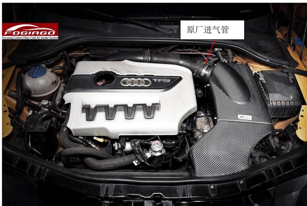
**安装步骤：**1,将原厂定位胶塞装到碳纤对应的支架上，然后对位装风箱底，对应的位置装好螺丝锁紧；2 将原厂进气管套进风箱底圆孔位，内侧套上硅胶管，再对接碳纤管，然后套上冬菇头锁紧。
