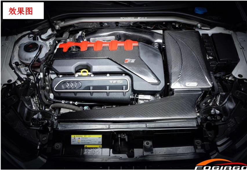
**安装步骤:** 1 先将导风管插入风箱底, 同步装车, 先对位导风管位置, 对位后先螺丝固定, 勿锁紧, 然后对位风箱底安装位, 对位后按实卡扣; 2 套上硅胶安装进气管, 接上卡管, 硅胶软管, 冬菇头, 锁上定位螺丝; 3 安装风箱盖锁紧。
