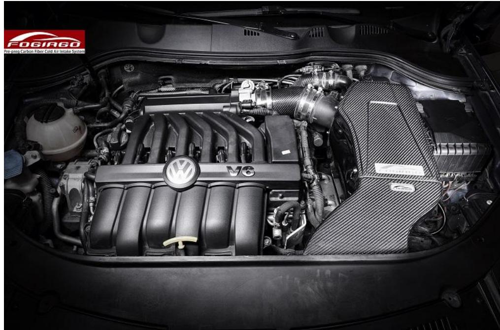
安装步骤：1, 将原厂风箱上的带感应器管拆下，原厂定位胶塞，螺丝拆下，然后装到碳纤风箱对应的位置；2, 按图依次安装，所有胶塞及螺丝均用回原厂。
