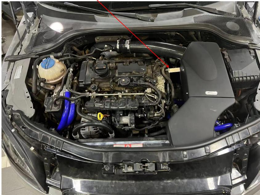
**安装步骤:** 1,先安装碳纤风箱, 前面用所搭配的 M4 螺丝固定锁紧, 然后再摆放固定支架, 标记风箱侧面的螺丝位, 再开孔, 装上螺丝固定支架连接风箱; 2, 套上硅胶, 安装进气长短管, 然后后再接上冬菇头, 装回风箱盖板, 套上感应器。
