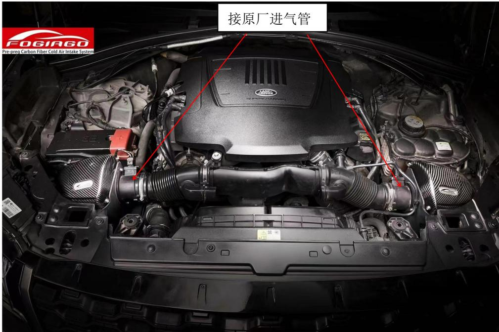
**安装步骤:** 1 先将原厂胶塞及进气管拆下安装到碳纤风箱底座上, 然后接上冬菇头滤芯锁紧, 2 将组装好的风箱对准原厂位装车, 对接进气管锁紧, 装回感应器; 3 套上入风管, 装回风箱盖锁紧。
