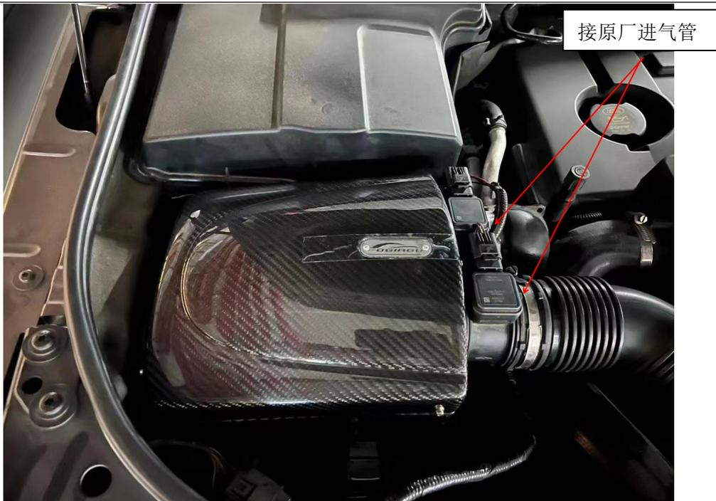
**安装步骤:** 1 先将原厂进气管拆下安装到碳纤风箱底座上, 然后接上冬菇头滤芯锁紧, 装回风箱盖锁紧; 2 将组装好的风箱对准原厂位装车, 套上废气管, 对接进气管锁紧, 装回感应器。
