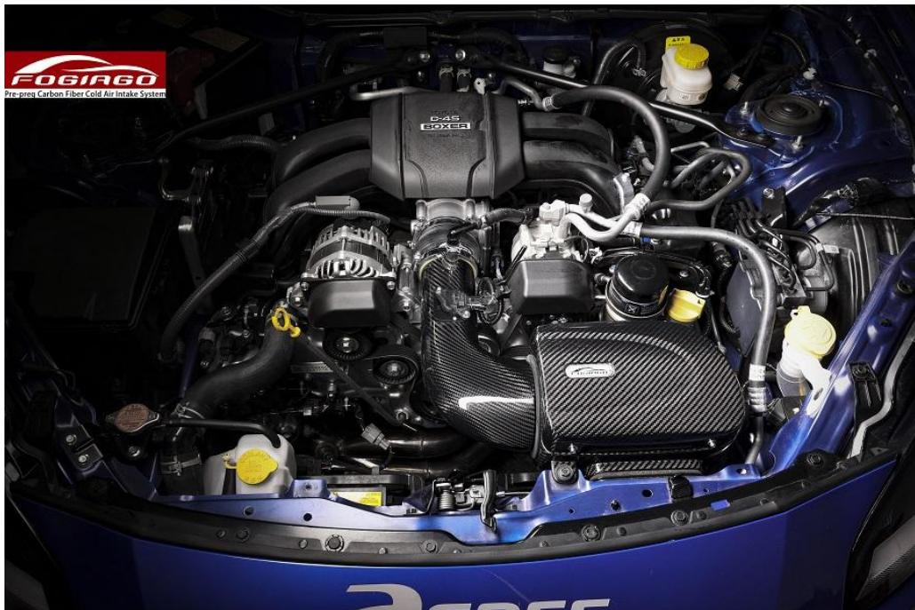
**安装步骤:** 1 先将原厂胶塞、螺丝拆下，装到碳纤风箱对应的支架上；2 发动机端口套上硅胶，将进气管套进风箱，然后对位装车，支架上用原厂螺丝固定锁紧；3 风箱内侧装上冬菇头锁紧后装回风箱盖；4 将废气管插入碳纤进气管上的小硅胶管，用小喉箍锁紧；5，安装感应器并锁紧。
