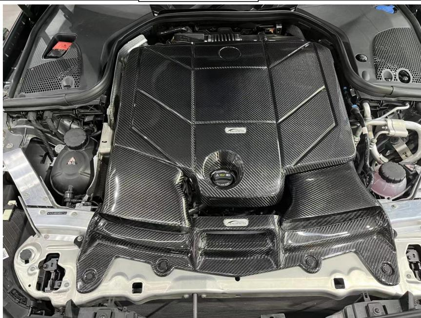
**安装步骤：**1，安装碳纤引擎盖，原厂位扣紧；2，拆下导风板两侧原厂螺丝及胶扣，然后安装碳纤导风板，用原厂螺丝，胶扣锁紧；3，安装左右进气管，与导风板连接处用螺丝固定锁紧。
