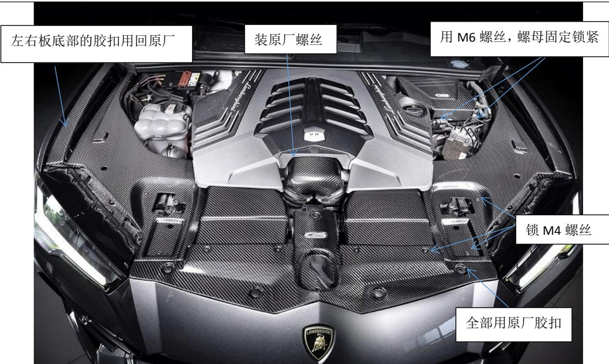
安装步骤：1，拆下要替换的原厂件；2，先安装碳纤进气管和风格，进气管螺丝用回原厂；3，套上左右导风管，安装前机舱罩，机舱罩胶扣用回原厂，导风管连接处用配套螺丝锁紧；4，安装左右机舱罩，底部胶扣用回原厂，与前罩连接处用配套螺丝锁紧；5，安装电脑板，用配套的 M6 螺丝、螺母固定锁紧。
