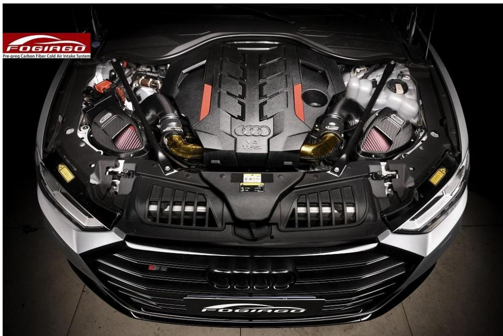
**安装步骤：**1，拆下原厂原厂风箱，进气管，顶巴；2，将冬菇头放进碳纤风箱内，套上进气管将冬菇头锁紧，装回盖子；3 将组装好的碳纤风箱按原厂位装车，硅胶管连接进气管，用喉箍锁紧即可，然后装回原厂顶巴。
